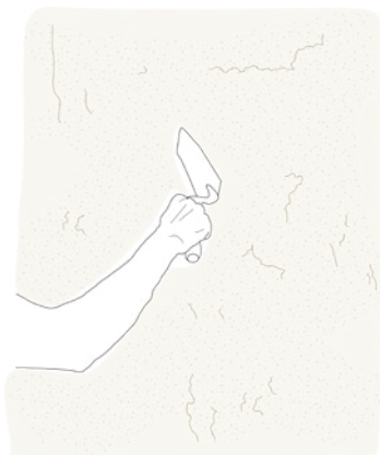
Application d'un enduit chaux
